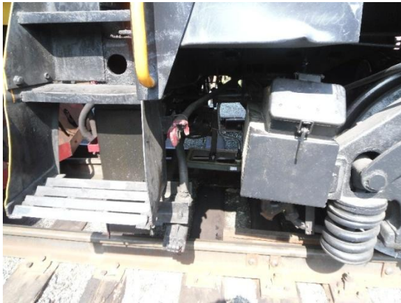
Установка считывателя путейых приемответчиков (СПП) на тепловозе
