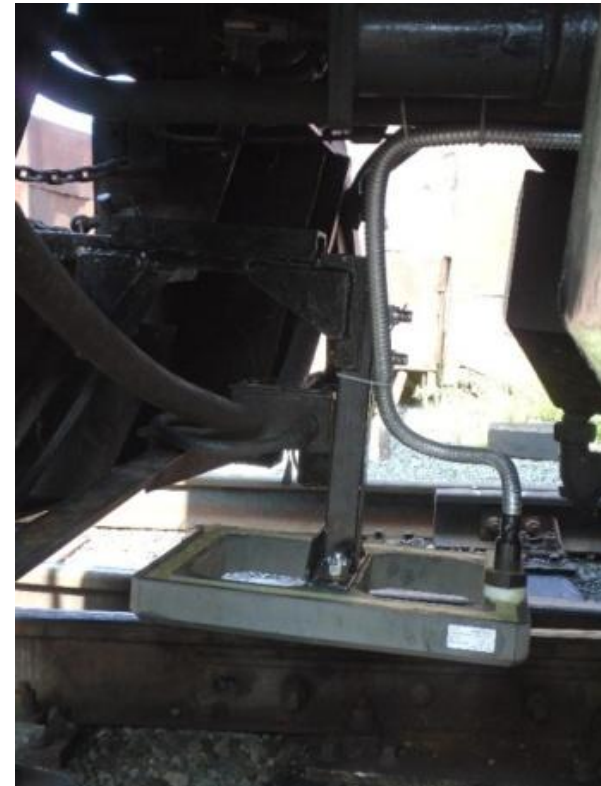
Внешний вид считывателя путейых приемответчиков (СПП)
