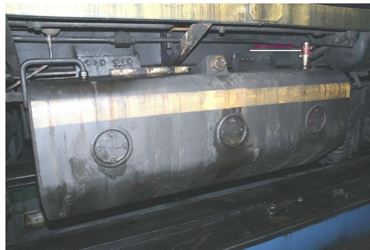
Установка датчика на топливный бак
